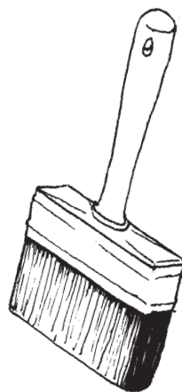
Nutida plafondpensel. Har en mycket vid användning, företrädesvis för vattenbaserade färger. Ill. Bertil Bonns.
